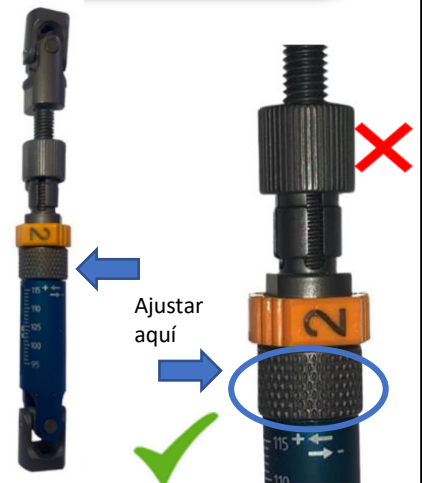
Figura 9: Puntos adecuados para el ajuste de las barras telescópicas
