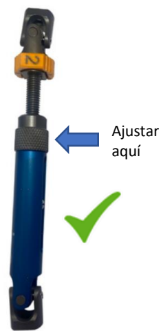
Figura 9: Puntos adecuados para el ajuste de las barras telescópicas
